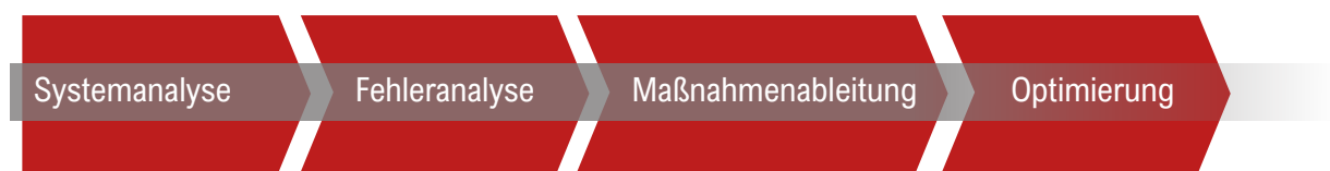
Abbildung 9: Die Phasen einer System-FMEA
